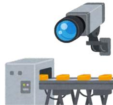
不良品を自動で検知。ロボットと組み合わせれば、不良品の排除まで自動で出来る。
